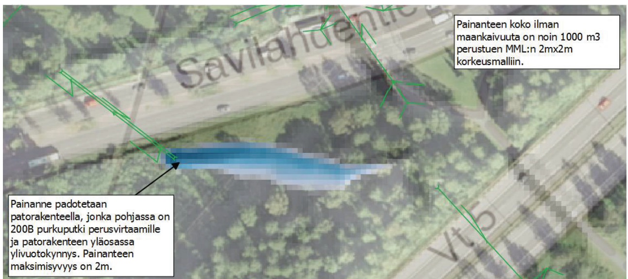
Kuva 22. Savilahdentien ja VT5 välissä sijaitsee maaston painanne, jota on mahdollista hyödyntää hulevesien viivytyksessä.
