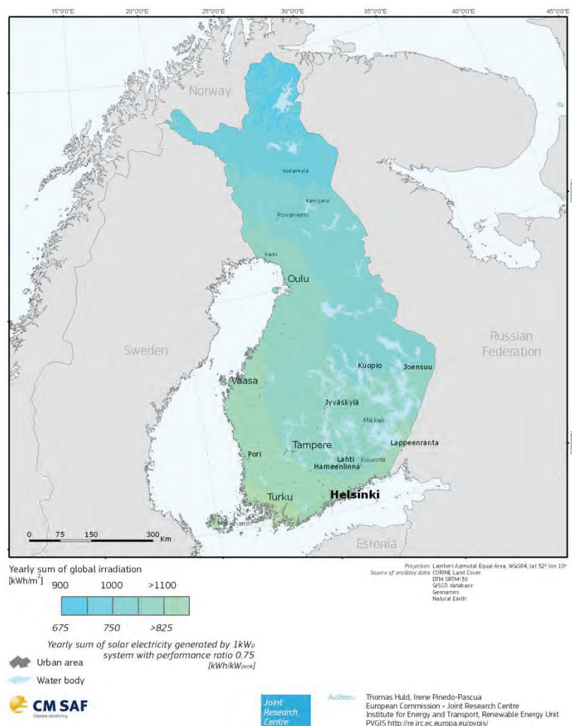
Kuva 2-15 Globaalisäteilyn määrä vuodessa (kWh/m 2 , väriskaalan yläpuolinen asteikko) sekä optimaalisesti asennetuilla aurinkopaneeleilla saavutettava vuosituotanto tehoyksikköä kohden (kWh/kW p , väriskaalan alapuolinen asteikko). (Kartta: Šuri 2007; Huld 2012 / IET)
