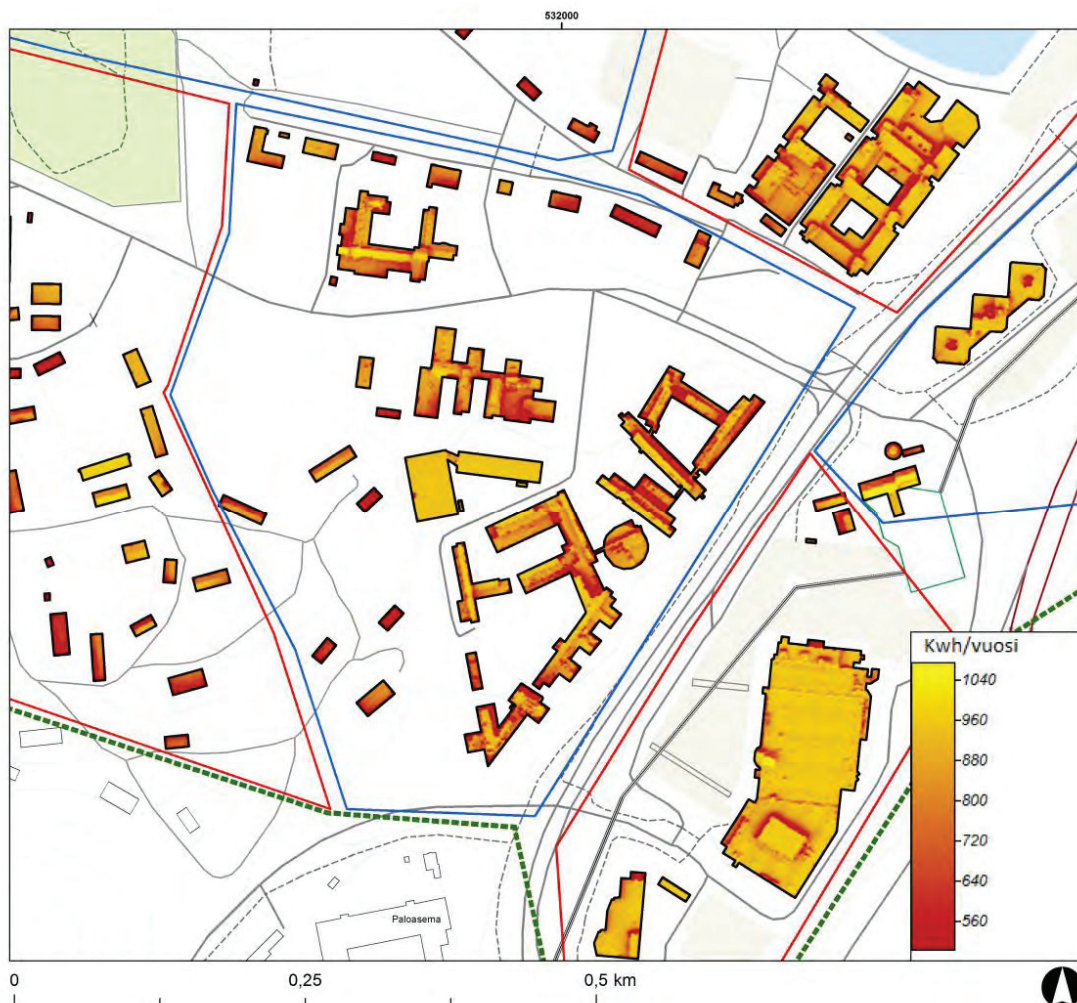
Kuva 5-6 Auringon kokonaissäteilyenergia (kWh/m 2 /vuosi) Microkadun alueelle vuoden 2011 rakennuskannan kattopinta-aloille.
