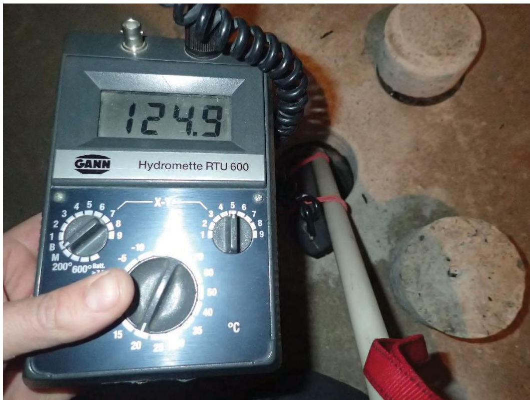
Kuva 7. Mittaus poratusta reiästä bitumikerroksen alapuolelta.
