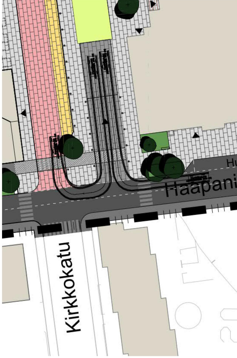
Kuva3. Ote liikenteen yleissuunnitelmasta. Kaupungin yleisen pysäköintilaitoksen liittymä.
