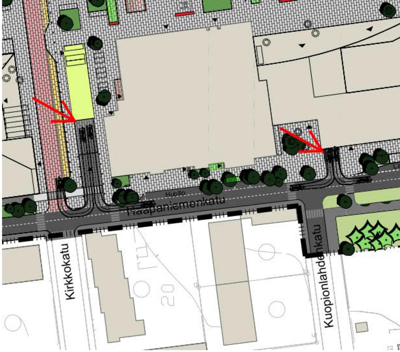
Kuva1. Ote liikenteen yleissuunnitelmasta. Pysäköintilaitosten liittymät korotettu nuolella.
