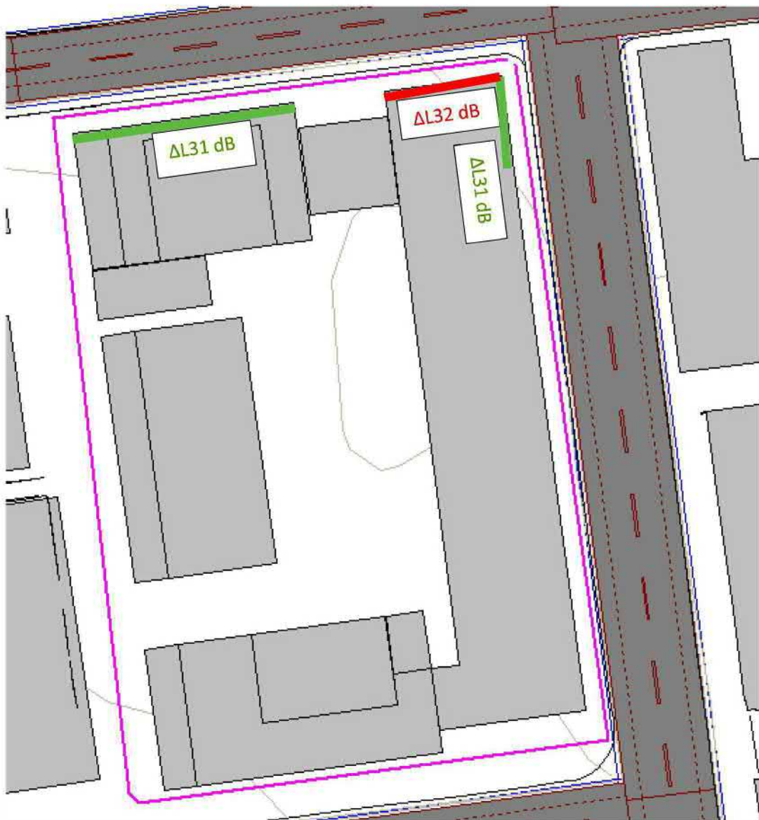
Kuva 6. Suositukset julkisivunosien ääneneristävyyden vaatimuksille.
