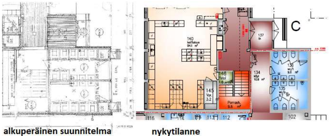
Kuva 6 Alkuperäinen rakennuspiirustus ja nykytilannekuva. Alunpitäin liitosassa oleva wc-alue on yksikerroksinen.
