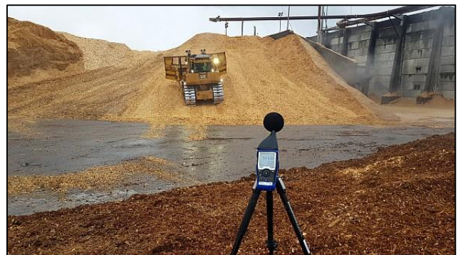
Kuvat 1 ja 2. Valokuvat mittauspisteistä. Mittauspiste telakoneen sivulla (vasen) ja takana (oikea).
