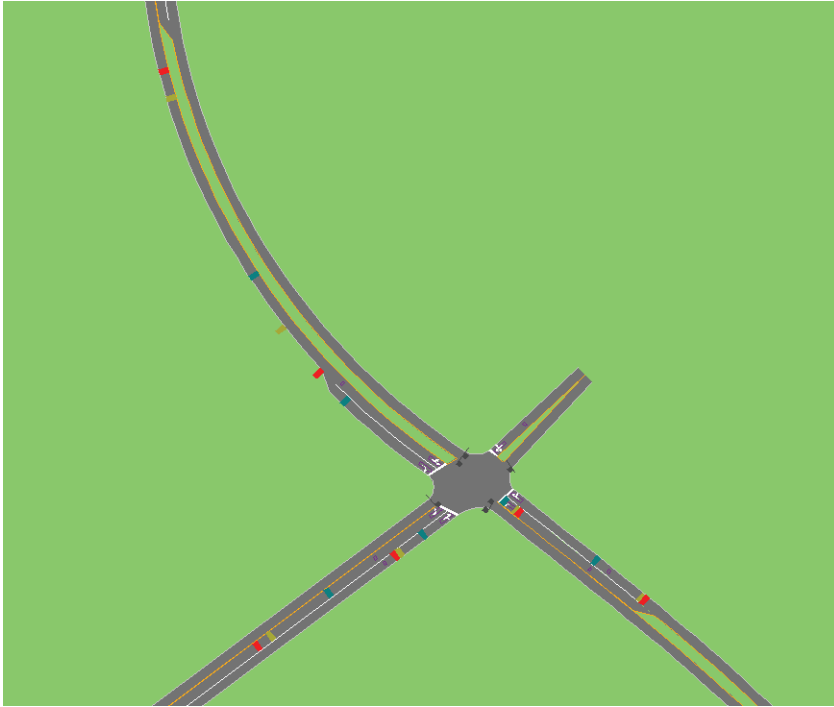
Kuva 3: Jonot kasvavat pitkiksi Saaristokadun pohjoishaaralle, mutta ne ovat lyhytaikaisia. Punainen merkki tarkoittaa simuloinnissa havaittua maksimijonopituutta.
